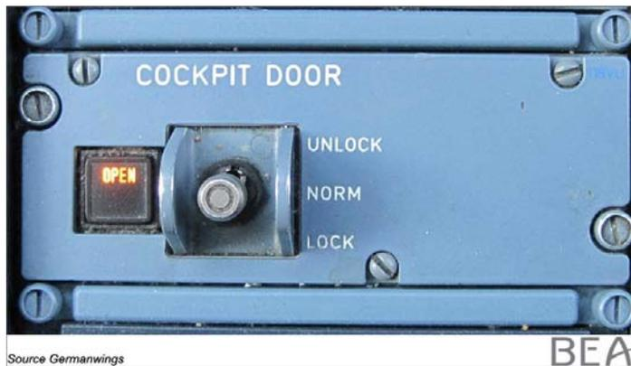
Figure 5 - interrupteur de contrôle de la porte
