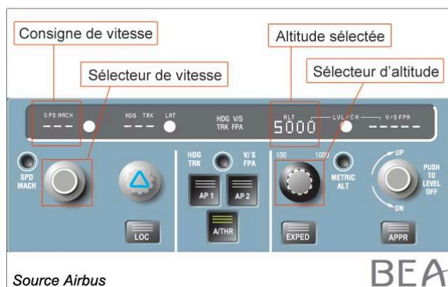
Figure 7 - partie du panneau de contrôle FCU
